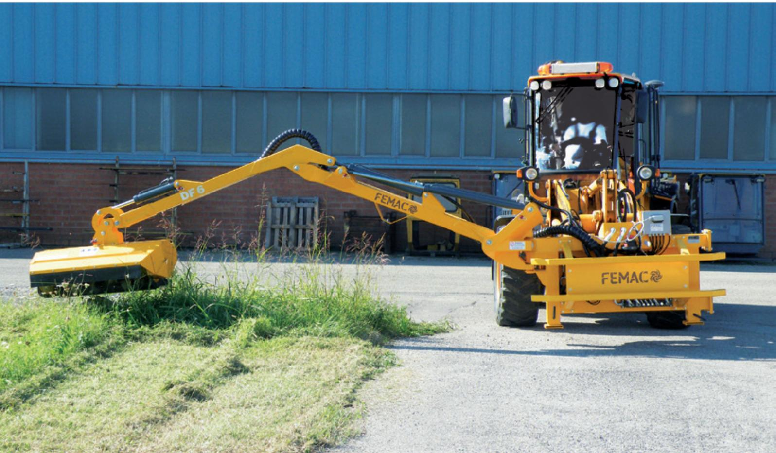
Decespugliatrice idraulica a braccio con spostamento laterale e rotazione posteriore di 90° con sicurezza idraulica antiurto per terne e simili, ideale per lavori su strade urbane ed interurbane.
