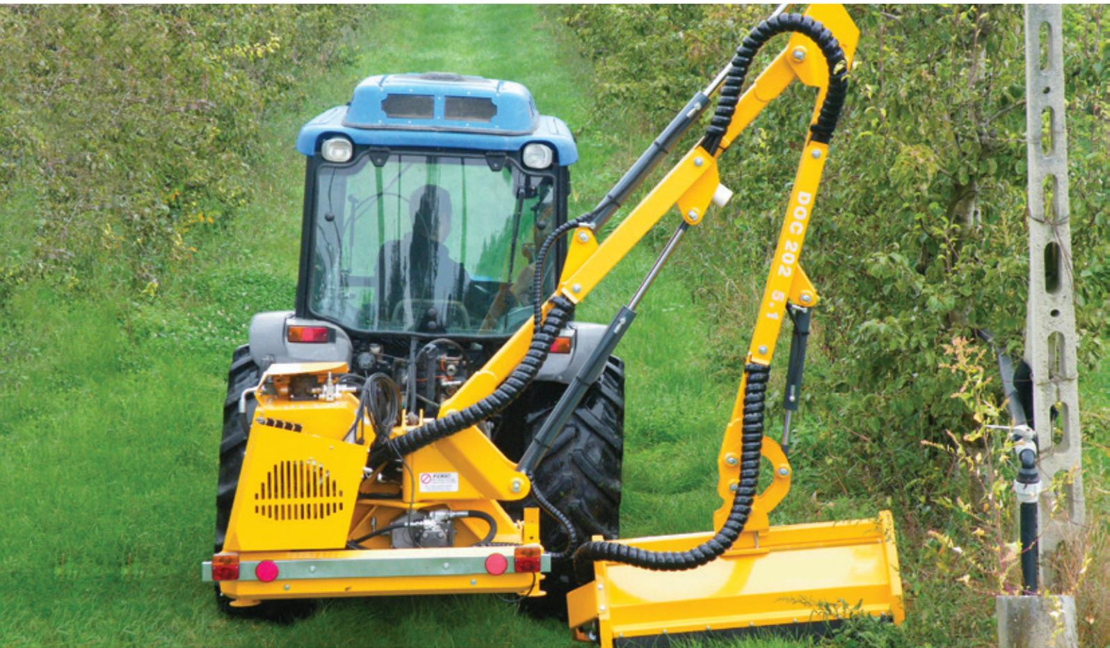
Decespugliatrice idraulica a braccio con spostamento laterale e rotazione posteriore di 90° con sicurezza idraulica antiurto per trattori di 50/70 HP e 2400/2800 kg di peso, ideale per lavori su strade urbane ed interurbane e per aziende agrarie.
