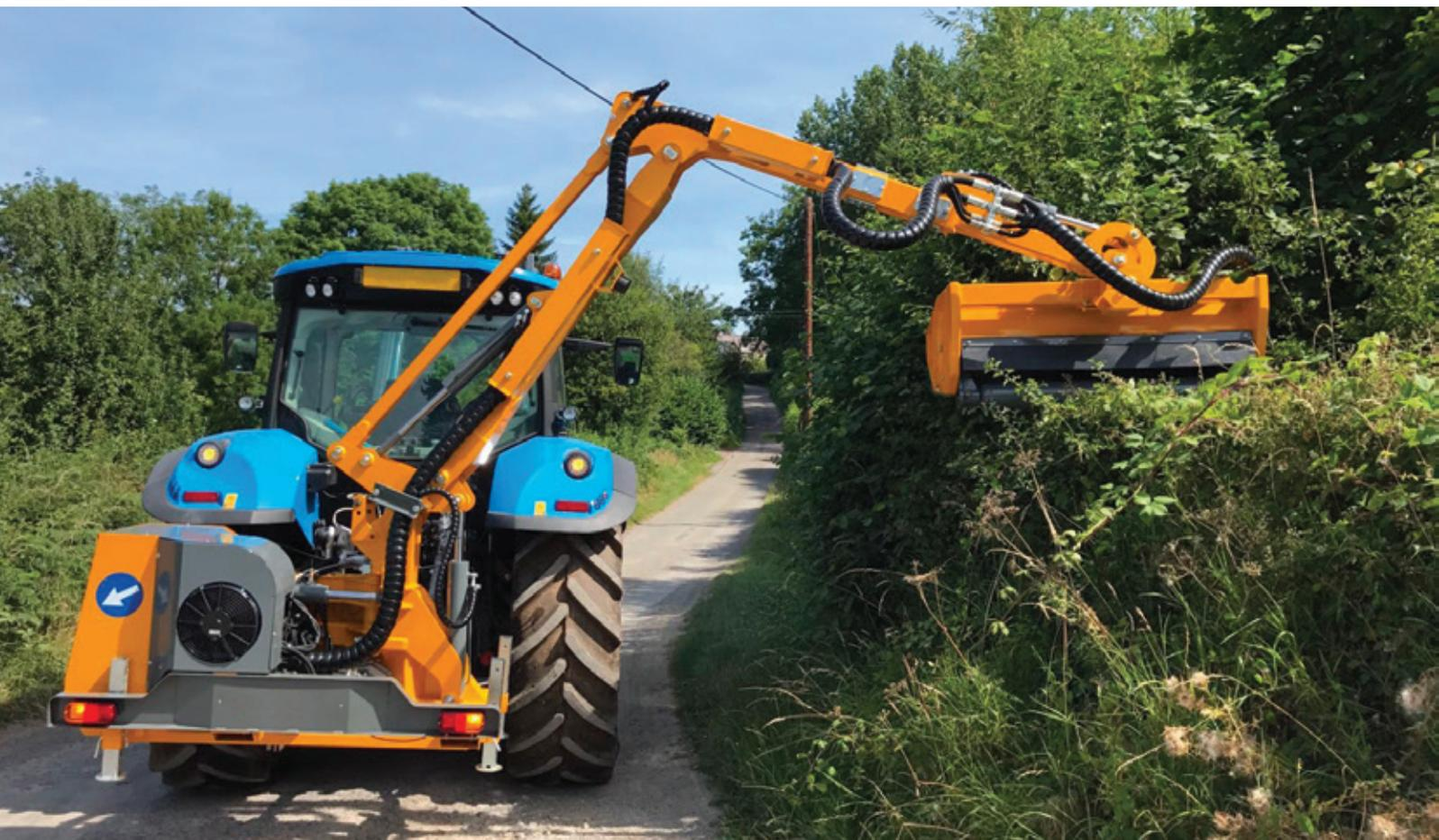
Decespugliatrice idraulica a braccio con spostamento laterale e rotazione posteriore di 100° con sicurezza idraulica antiurto per trattori di 80/130 HP e 3500/4500 kg di peso, ideale per lavori su strade urbane ed interurbane e per aziende agrarie.
