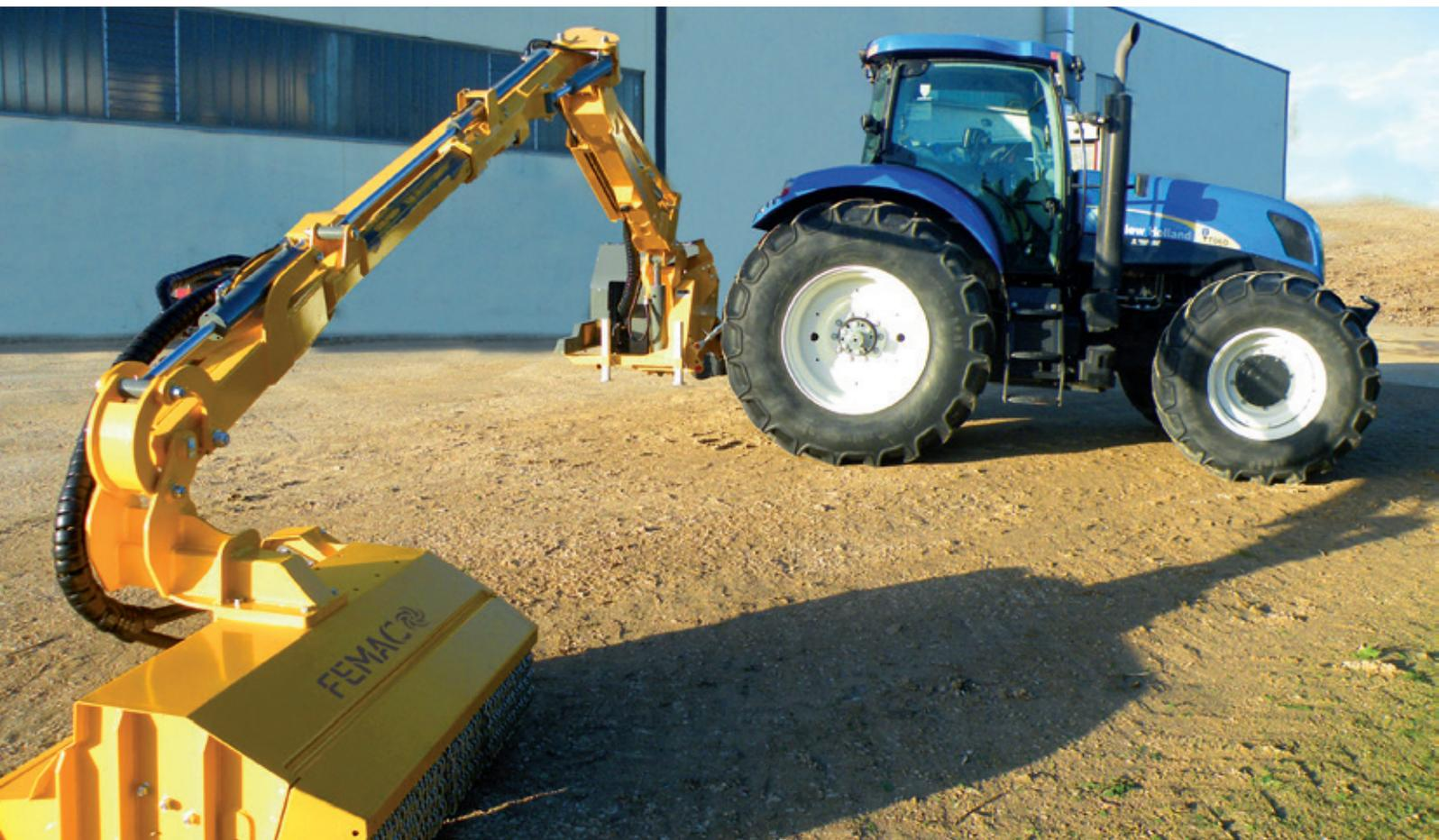
La VFR 8T unisce tre importanti caratteristiche: la geometria a parallelogramma, un terminale telescopico e l'avanzamento a lato cabina. Queste caratteristiche sono fondamentali per avere facilità di lavoro in spazi stretti con bracci decespugliatori lunghi e tutto il confort della testata trinciante a lato cabina per una maggiore visibilità.
